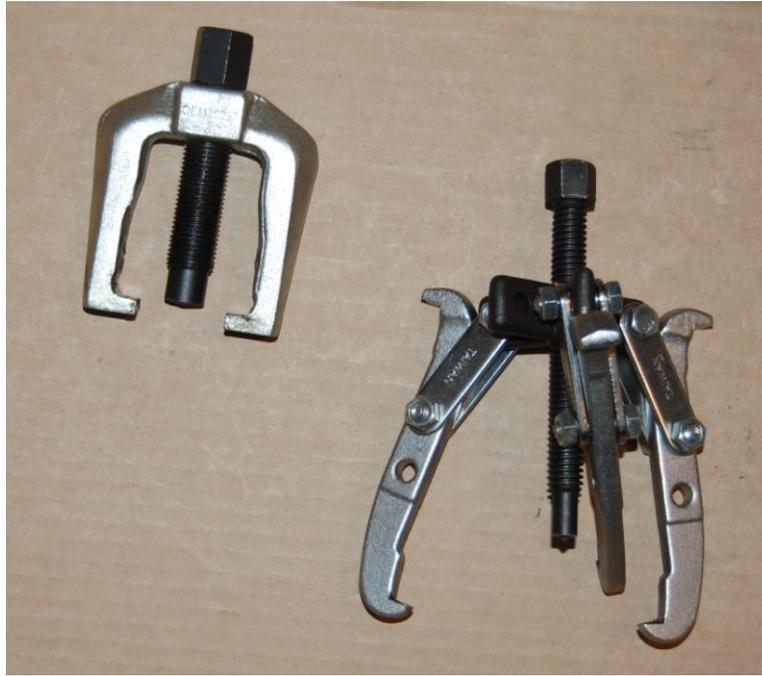
Tie-rod end puller. 3-jaw puller.
